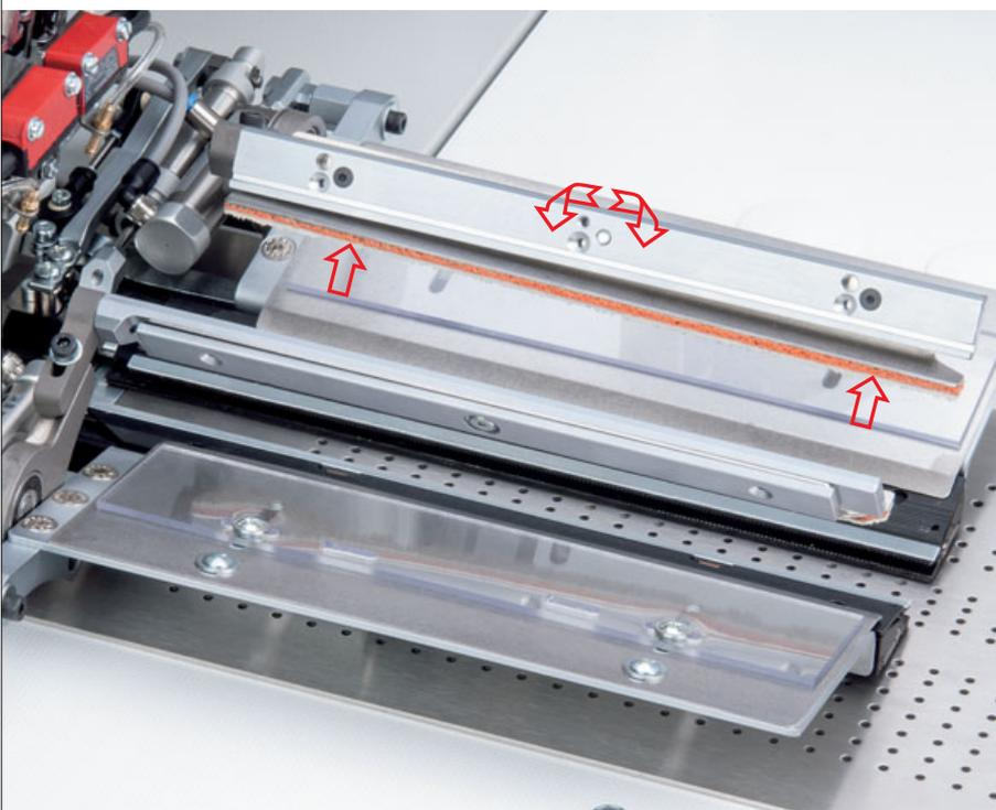
**Die Klammerleisten** sind sowohl flexibel als auch mit Vorspannung einstellbar. Dies unterstützt den Ausgleich von unterschiedlichen Materialstärken. Zudem verteilen die Klammerleisten gleichmäßig Druck auf die Patten. Zum einfacheren Einlegen der Paspel werden die Pattenklappen weiter geöffnet. Die Gummierung an den Pattenklappen verhindert unnötige Abdrücke im Material und gibt besseren Halt.
