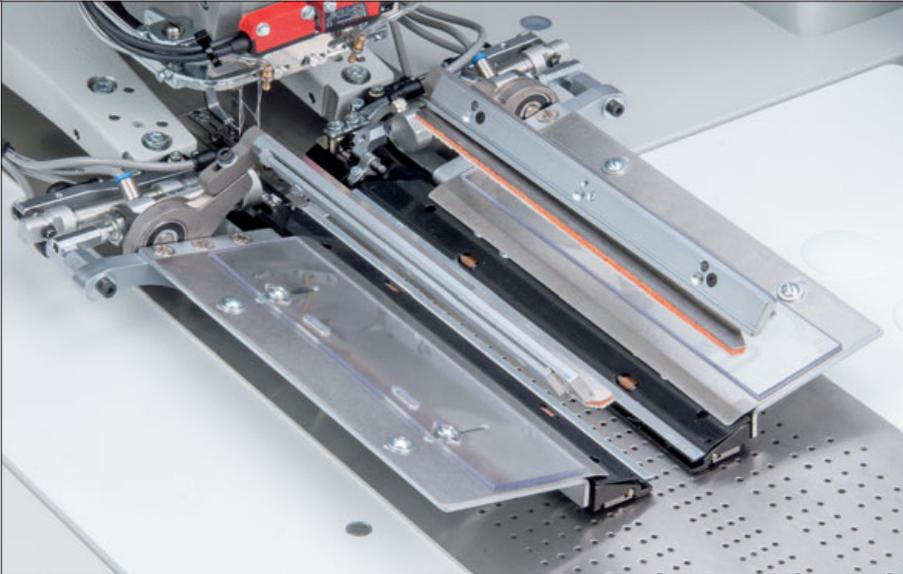
**Technisches Highlight – die Transportklammer K35L** verbessert die Nahtqualität durch ihre einfache und flexible Justagemöglichkeit für eine perfekte Anpassung an die Anwendung.
