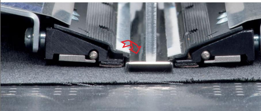
**Das spezielle Faltsystem der Transportklammer** sichert die automatische Anpassung an die Materialstärke.
