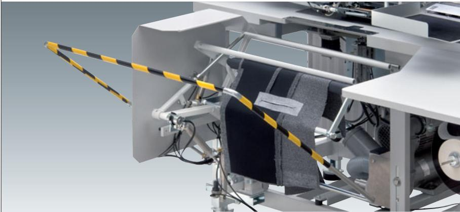
**Überwurfstapler (0745 427554)** zum sauberen Abstapeln von langen Teilen. Der Überwurfstapler senkt sich in der Arbeitshöhe mit wachsender Bündelgröße ab.
