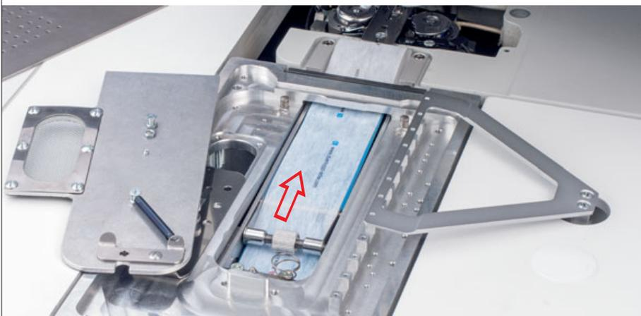
**Bandzuführeinrichtung mit Abschneideautomatik** – schrittmotor-gesteuert (B169 590234) – für das automatische Zuführen und Schneiden des Verstärkungsstreifens von der Rolle
