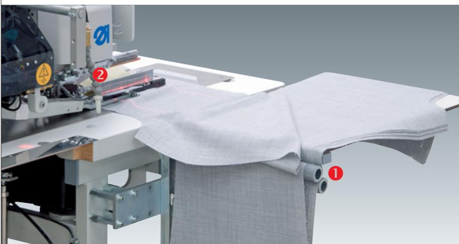
**Die Bündelklemme mit Auflagetisch (1970 593194)** ❶ ist empfohlen in Verbindung mit der Ausrollvorrichtung (0745 598394) oder mit der Ausblasvorrichtung (0745 598444) ❷.
