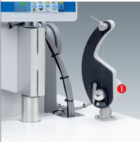
**Separat angetriebener Spüler** ❶ für schnelle Farbwechsel
