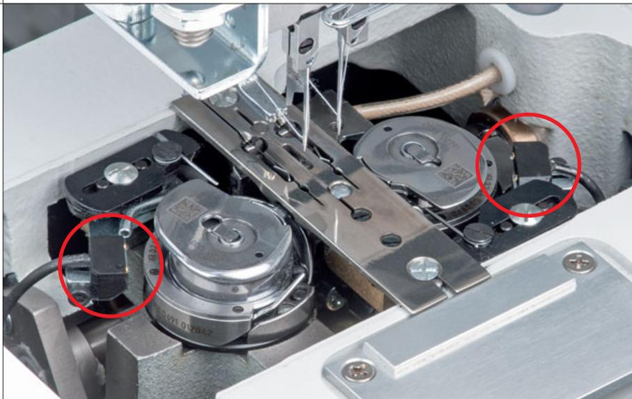
**Die Spulenrestfadenwächter** sind in der Grundausstattung der Nähanlage enthalten. Reduzierter Spulenwechsel durch großen Greifer.
