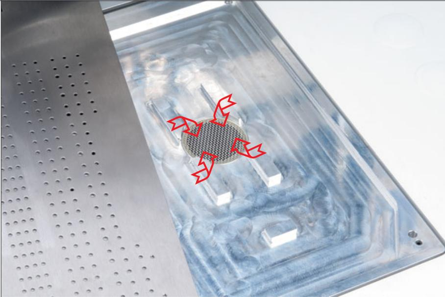
**Ansaugvorrichtung** (Vakuum 0745 598424) zum genauen Positionieren des Nähgutes. Steht keine zentrale Vakuum-Versorgung zur Verfügung, ist zusätzlich das Vakuumgebläse (1970 593314) erforderlich. Eine justierbare Ansaugvorrichtung gibt es in Verbindung mit der Bandzuführung (B169 590234) für Futtertaschenverarbeitung.
