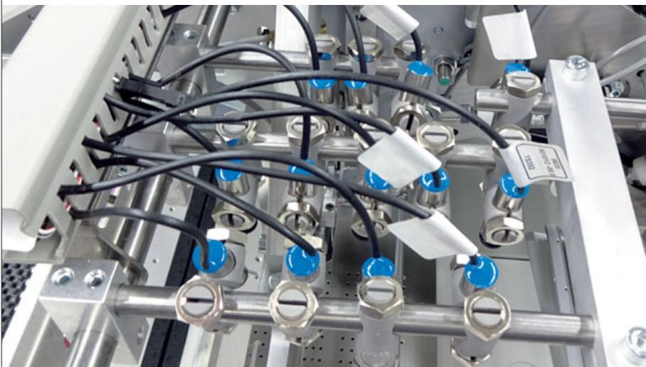
**Bis zu 16 Lasermarkierungsleuchten** sind optional aufrüstbar – Bausätze mit 2, 3 und 8 Lasermarkierungsleuchten sind verfügbar.
