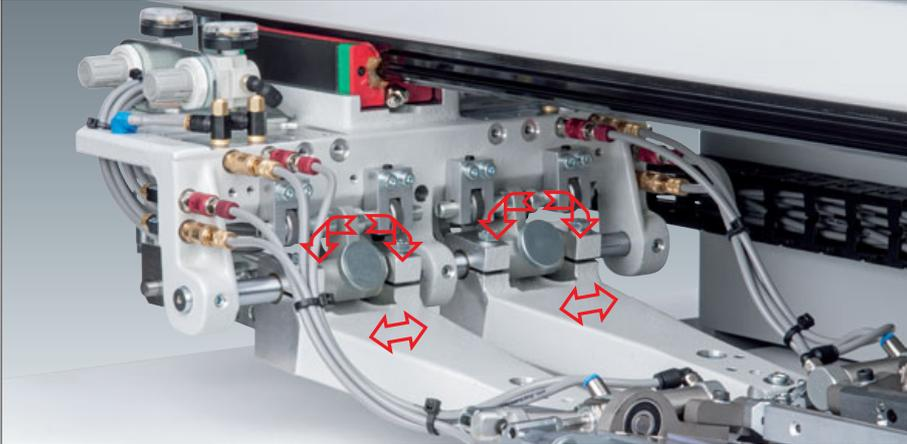
**Integrierte mechanische Klammerschnellverstellung** für den manuellen Wechsel von Einfach- auf Doppelpaspel-Anwendungen
