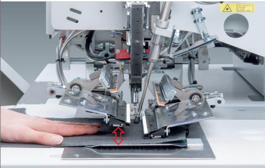
**Zum Ausstreifen des Nähgutes** können die Transportklammern separat voneinander abgesenkt werden (programmierbar). Die Transportklammer K35L bietet sicheren Halt des Nähgutes bei dem Transport von schwierigen Materialien – der erhöhte Maximaldruck ist für die linke und rechte Klammer separat regulierbar.
