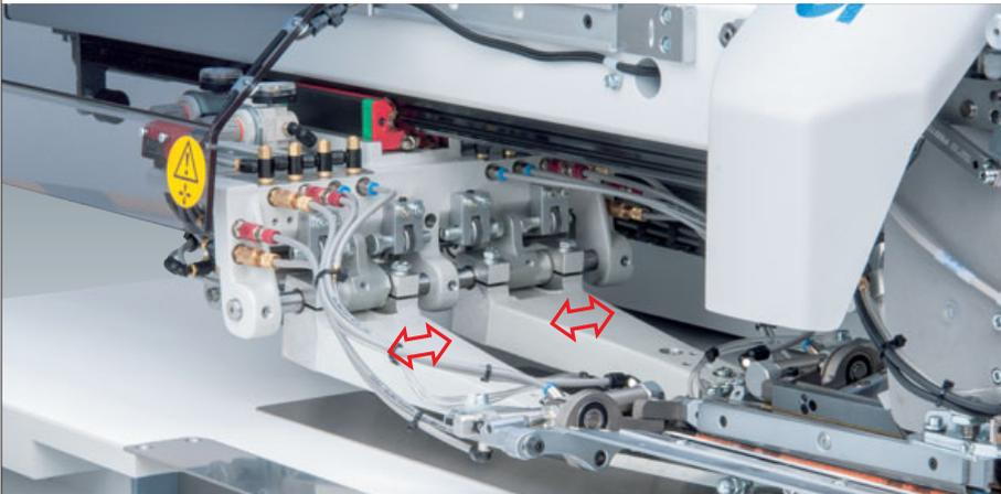
**Integrierte pneumatische Klammerschnellverstellung** (Option 0745 567634) für die automatische Verstellung von Einfach- auf Doppelpaspel-Anwendungen für linke und rechte Klammer
